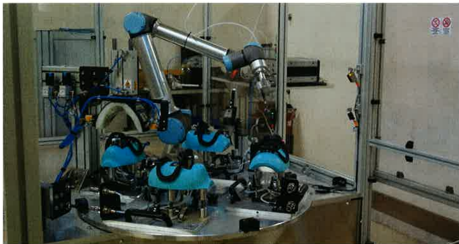
La produzione delle maschere M-21, realizzata da DBI nel sito di Tor Cervara, viene effettuata utilizzando macchinari robotizzati. (foto: Autore)
