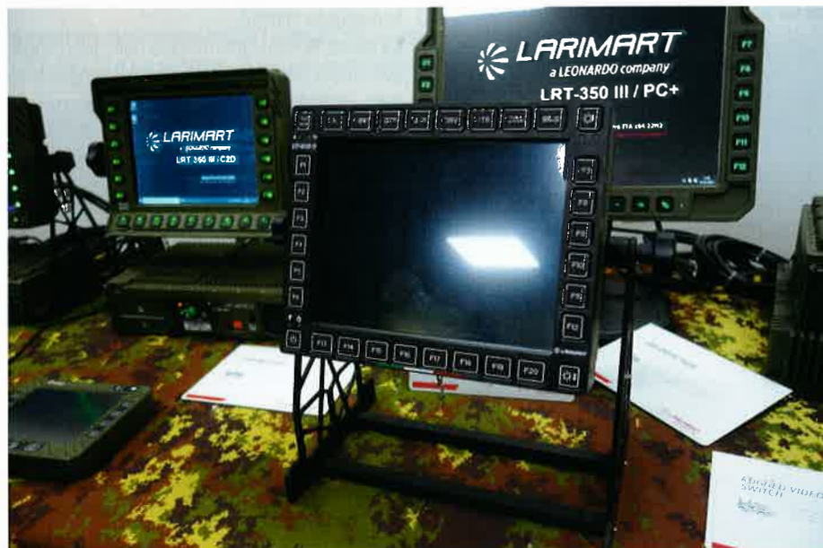
Il nuovo display (touch screen), realizzato in conformità con gli standard NGVA (NATO Generic Vehicle Architecture), è dotato di capacità di calcolo embedded. (foto: Autore)
