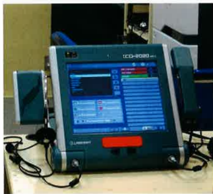
Il terminale XCO-2020 del sistema IPCOM-MS di gestione centralizzata delle chiamate in fonia. Tale foto è stata scattata in un Posto Comando di Reggimento dell'EI. (foto: Autore)
