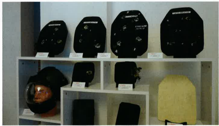
Alcune piastre balistiche dei giubbetti PBI dopo i test distruttivi. Tali piastre sono state ampiamente sovradimensionate: dovrebbero resistere a 2 colpi ma, in pratica, resistono quasi sempre almeno a 3 colpi (come si può notare dall'immagine). (foto: Autore)
